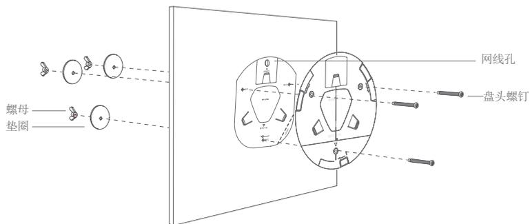
图3-4 固定安装架到天花板示意图
