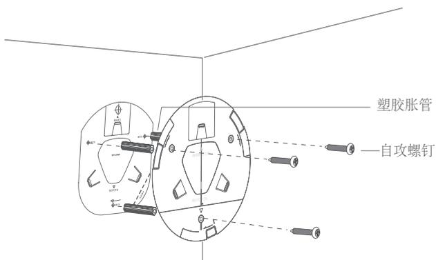
图3-11 固定安装架到墙面示意图
