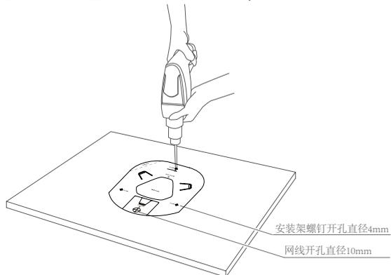
图3-3 钻孔示意图
